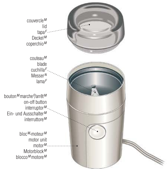
moulin M à café M coffee mill molinillo M de café M Kaffeemühle F macinacaffè M
